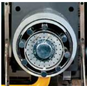
Příklad spalovací hlavy hořáku RS/M BLU
