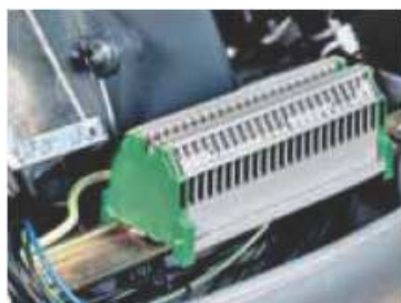
Příklad svorkovnice u modelů RS 68-120-160-200/M BLU
