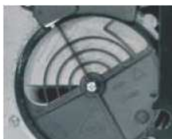
Vzduchová klapka částečně otevřena (GS3,GS5)
